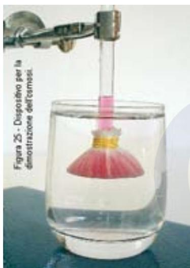
Figura 25 - Dispositivo per la dimostrazione dell'osmosi.
