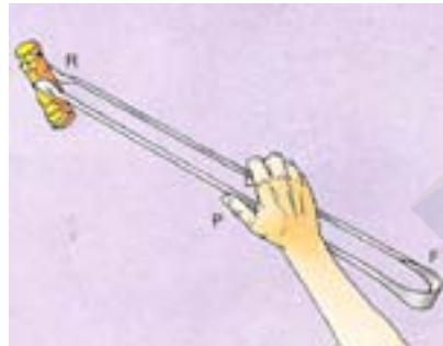
Figura 30 - Leva di terzo genere
