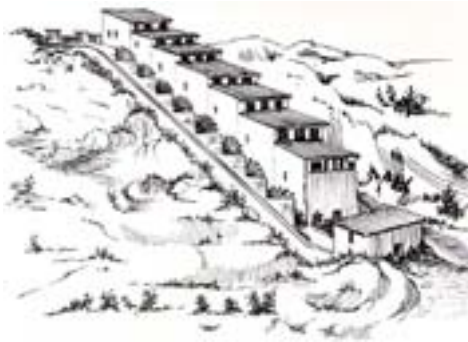
Figura 8 - Mulini di Barbegal: sorgevano su un pendio, al quale un acquedotto conduceva l'acqua
