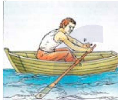
Figura 28 - Il remo è un esempio di leva di secondo genere
