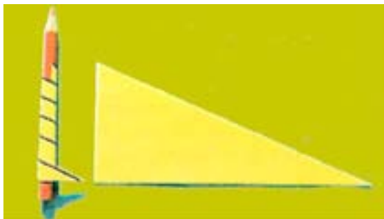
Figura 41 - Avvolgendo un piano inclinato su se stesso otteniamo la vite
