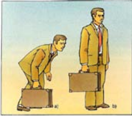
Figura 15 - Sollevando la valigia si compie un lavoro reggendo la valigia no perché manca lo spostamento
